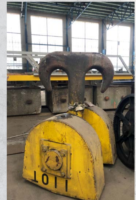
Bilden till vänster; rivningsarbete där krokarna fortfarande var på plats i Maskinverkstaden. En krok kunde lyfta hela 250 ton! Foto: Varvsstaden.
