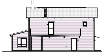
Fasad med förråd/carport/terrass
